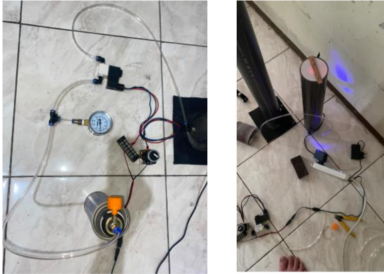
Gambar 4. 1 Dokumentasi Simulasi Gas Bocor
