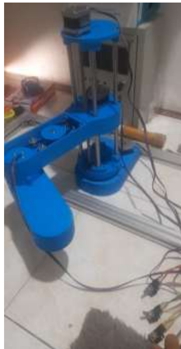
Gambar 4. 7 Pengujian Pengendalian Gerak Stepper Motor Menggunakan Rotary Encoder KY-040
