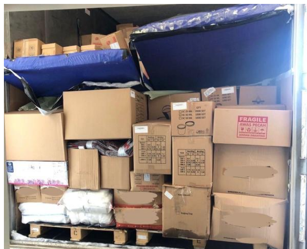
Gambar 4. 16 Kerusakan Sekat Pemisah Suhu pada Armada Multisuhu
