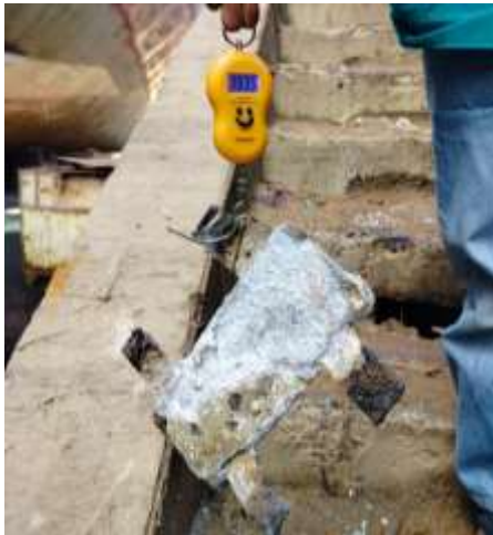
Gambar 4. 1 Perhitungan Berat Akhir Zinc Anode (Sumber: Penulis, 2026)
