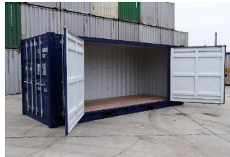
Gambar 2. 3 Open Side Door Container
