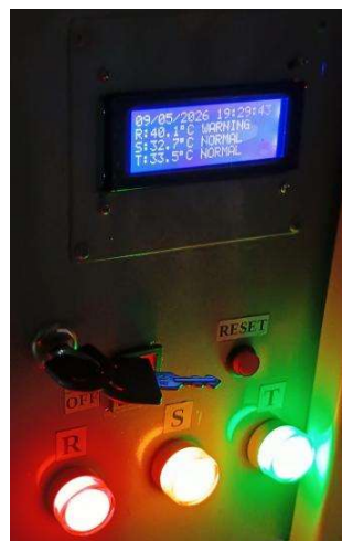
Gambar 5.5 Tampilan LCD saat Kondisi Suhu Peringatan
