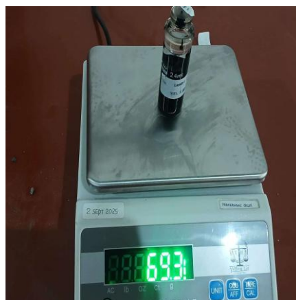
Gambar 3. 36 Menimbang berat Piknometer + Air + Aspal
