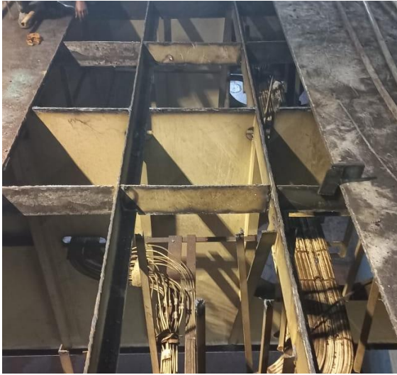
Lampiran 1 Proses pergantian pelat car deck (Sumber: Penulis, 2024)
