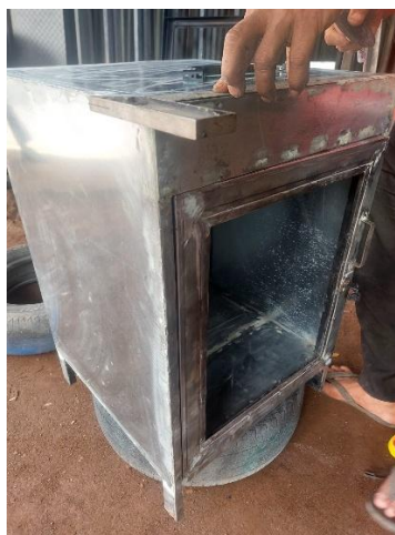
Gambar 4. 3 Pembuatan Kotak Pengisian Galon
