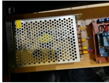
Gambar 4. 7 Pemasangan PCB dan PSU Pada Akrilik
