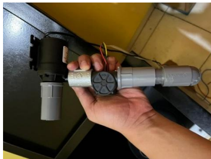
Gambar 4. 8 Perakitan Pompa dan Sensor Flowmeter
