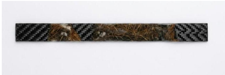
Gambar 4. 2 Spesimenn Pengujian Sesuai ASTM D3039
