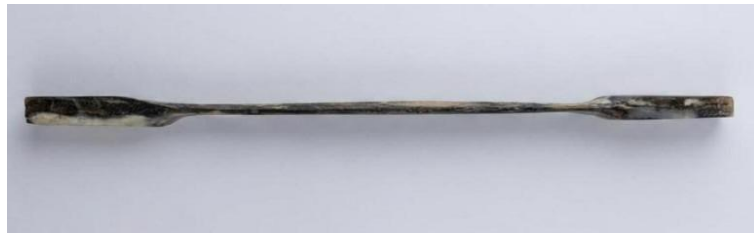
Gambar 4. 3 Spesimen Pengujian Sesuai ASTM D3039
