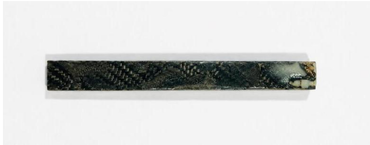
Gambar 4. 1 Spesimen Pengujian Sesuai ASTM D7264
