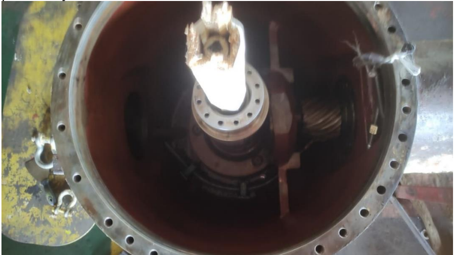
Gambar 4. 1 Bow Thruster dalam perbaikan (Sumber : Penulis 2026)
