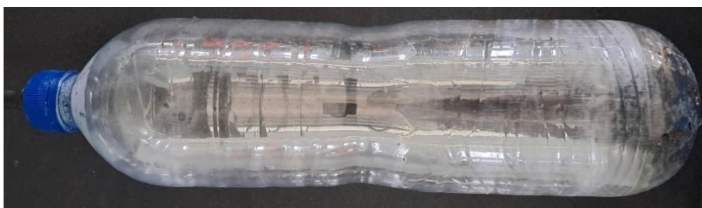
Gambar 4.6 Hasil perataan permukaan botol PET pada suhu 80 °C Tekanan 2,5 bar, waktu 4 menit (f), tekanan 3 bar, waktu 2 menit (g), Tekanan 3 bar, waktu 3 menit (h),tekanan 3 bar, waktu 4 menit (i)
