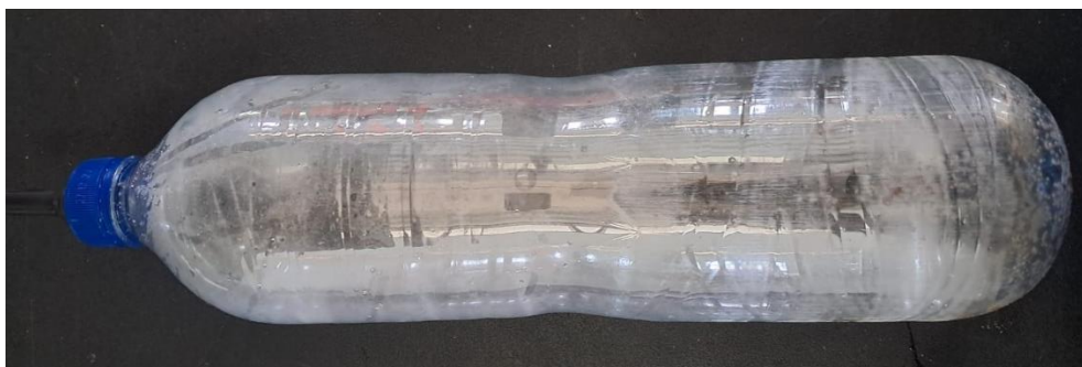
Gambar 4.6 Hasil perataan permukaan botol PET pada suhu 80 °C Tekanan 2,5 bar, waktu 4 menit (f), tekanan 3 bar, waktu 2 menit (g), Tekanan 3 bar, waktu 3 menit (h),tekanan 3 bar, waktu 4 menit (i)
