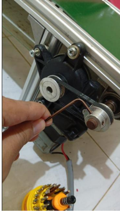
Gambar 3. 11 Pemasangan Pulley dan belt
