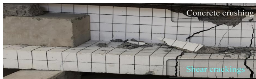
a) Pola keruntuhan eksperimen balok-T
