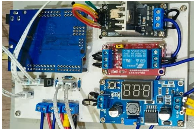
Gambar 4.3 Hasil perakita komponen pada papan PCB
