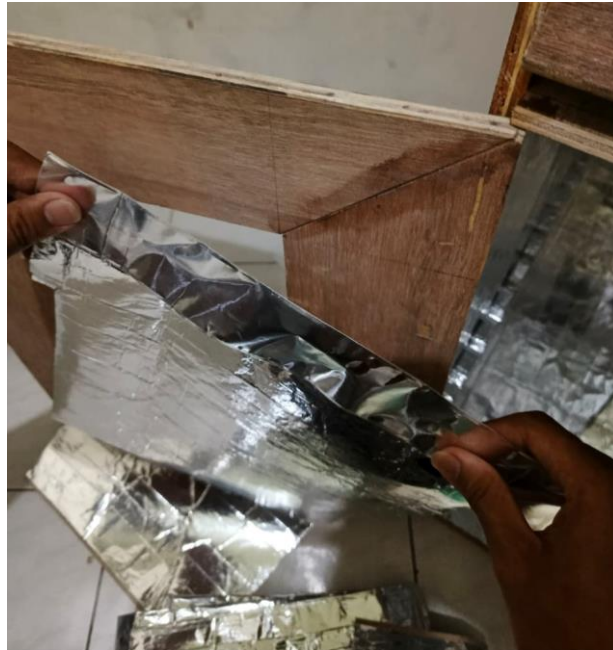
Gambar 4. 7 Proses Pemasangan Alumunium Foil dalam Box
