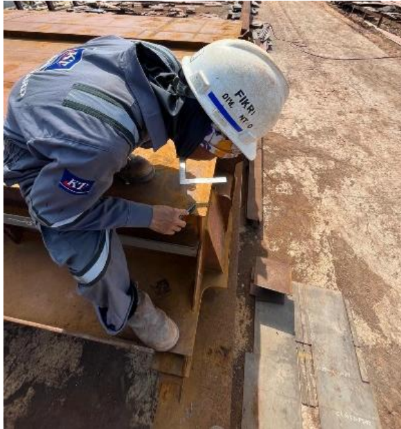
Gambar 2. 14 Visual Test (Sumber : Dokumentasi Pribadi)
