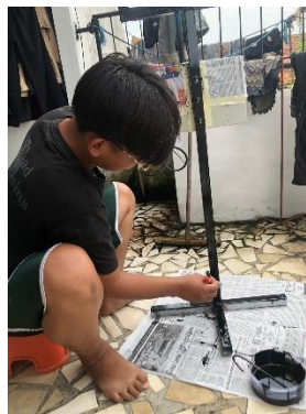
Gambar 4. 4 Proses pengecatan Rangka Tiang
