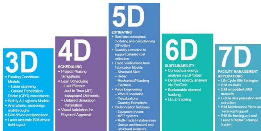
Gambar 2. 2 Dimensi BIM mulai dari 3D hingga 7D
