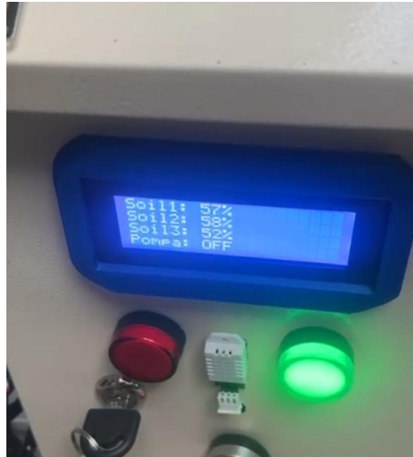
Gambar 4.6 Kondisi LCD Ketika Kelembapan Tanah di Bawah 60%
