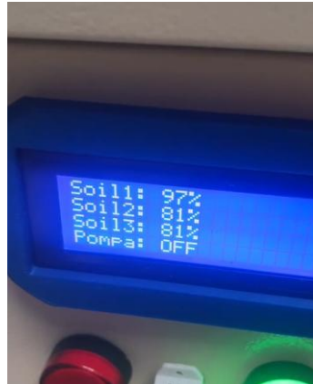
Gambar 4.19 Kondisi LCD saat Kelembapan Tanah di Atas 80%
