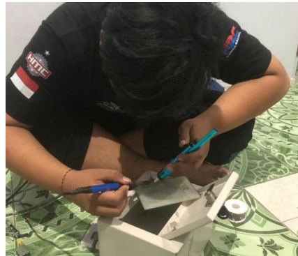
Gambar 4.5 Pemasangan dan Solder Komponen
