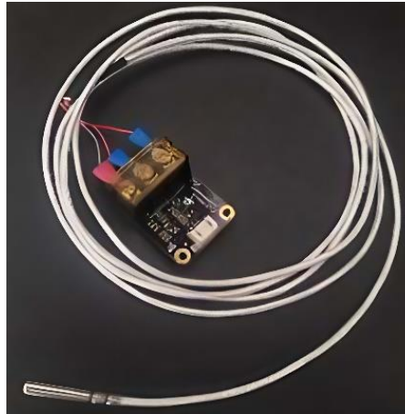
Gambar 2.20 Sensor RTD PT100 dan Sistem Kerjanya [35]
