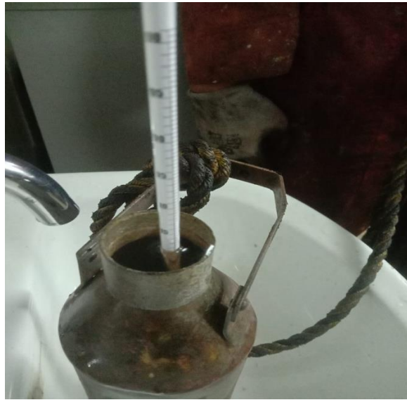
Gambar 4. 3 Validasi density air di MV. Navios Victory
