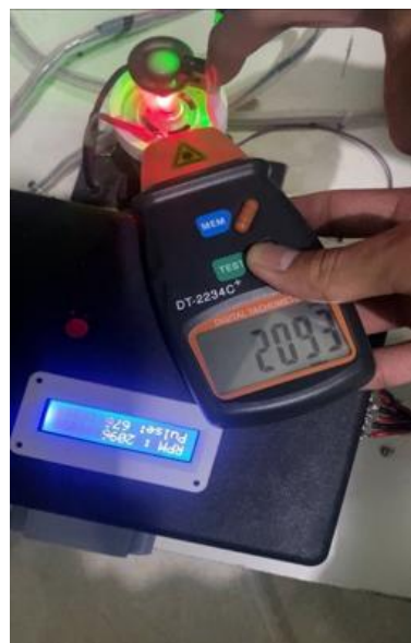
Gambar 4. 5 Pengujian Sensor FC-03 saat rpm diukur dengan tachometer mendapatkan hasil 2093.
