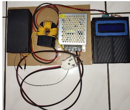
Gambar 5. 7 Pengujian menggunakan Beban Resistor 5Watt 0.22Ohm
