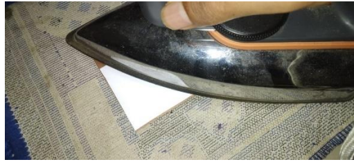
Gambar 4. 4 Menyetrika rangkaian PCB
