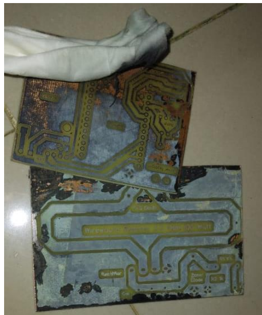
Gambar 4. 5 Membersihkan rangkaian PCB
