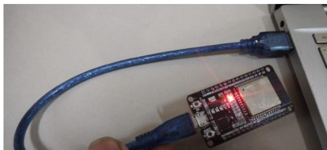
Gambar 4. 14 Penyambungan ESP32 ke Laptop
