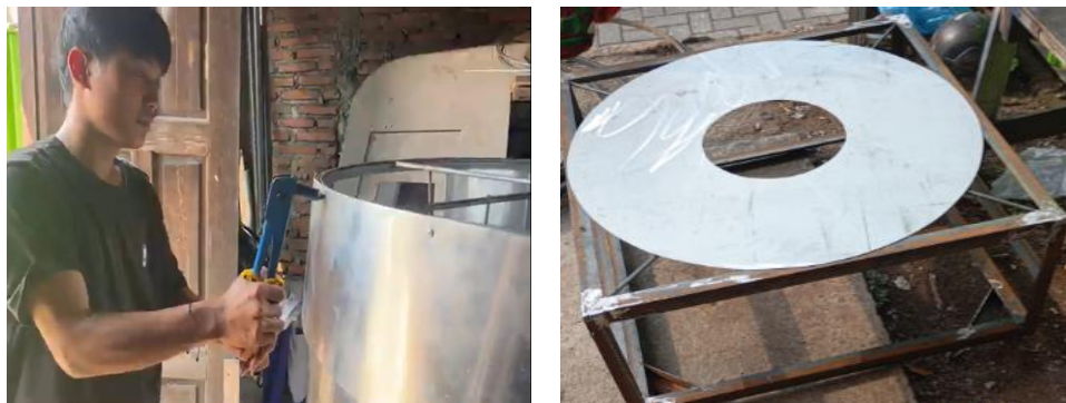
Gambar 4.4 Proses fabrikasi cover tabung dan cover bawah tabung
