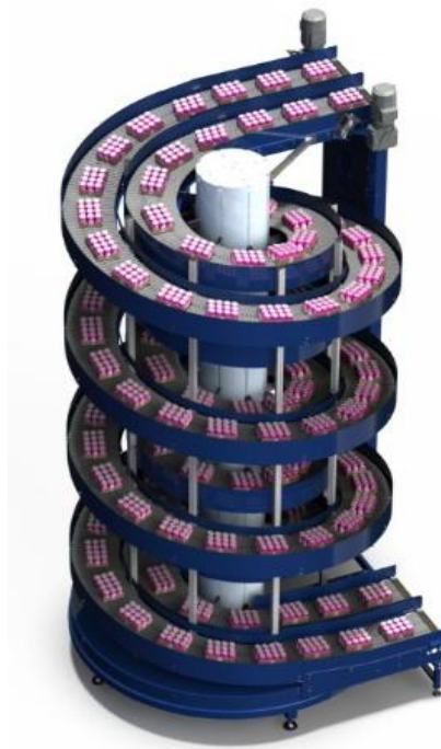
Gambar 2.4 Konsep spiral konveyor yang digunakan
