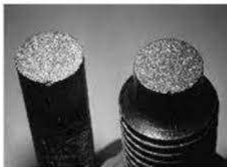
Gambar 2. 11 Patahan getas (Amyrezaa, 2015)
