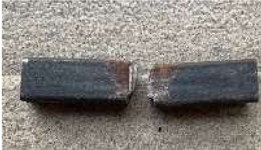
Gambar 4. 4 Patahan baja ST-37 tampak atas
