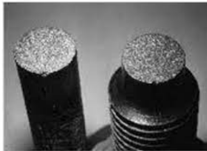
Gambar 2. 11 Patahan getas (Amyrezaa, 2015)
