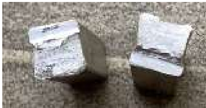
Gambar 4. 11 Patahan alumunium tampak depan
