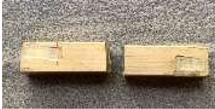
Gambar 4. 13 Patahan kuningan tampak atas
