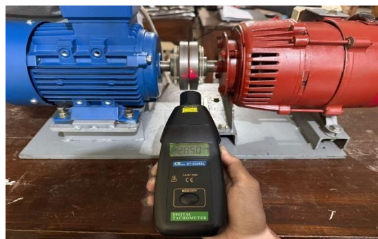
Gambar 2. 21 Pengecekan putaran mesin
