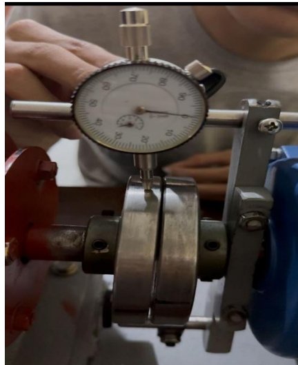
Gambar 4. 7 Pengujian bar sag posisi jam 12
