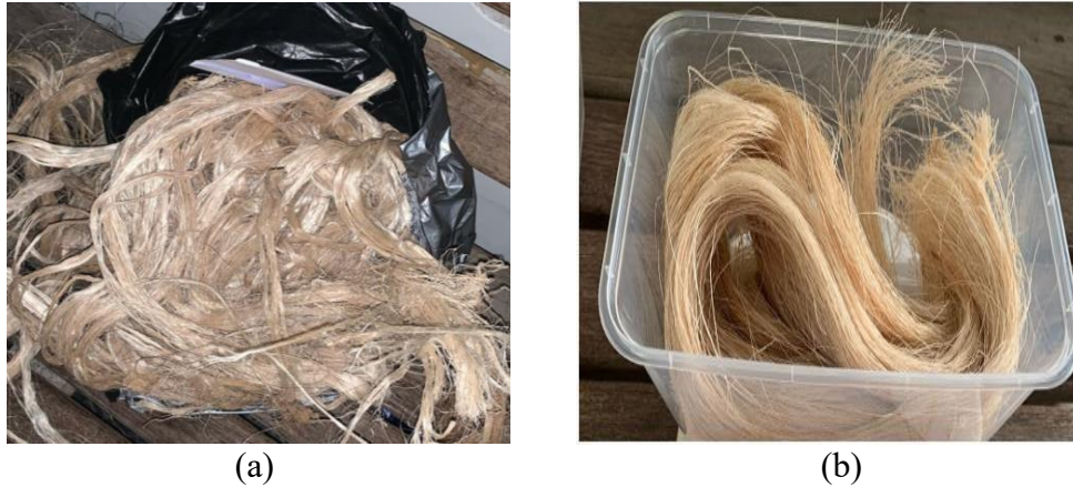
Gambar 4. 1 Serat yang belum dilakukan penyisiran (a), serat yang sudah dilakukan penyisiran (b)
