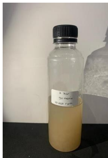
Gambar 4. 5 Spesimen setelah perlakuan putaran tinggi pada perlakuan 2 bar
