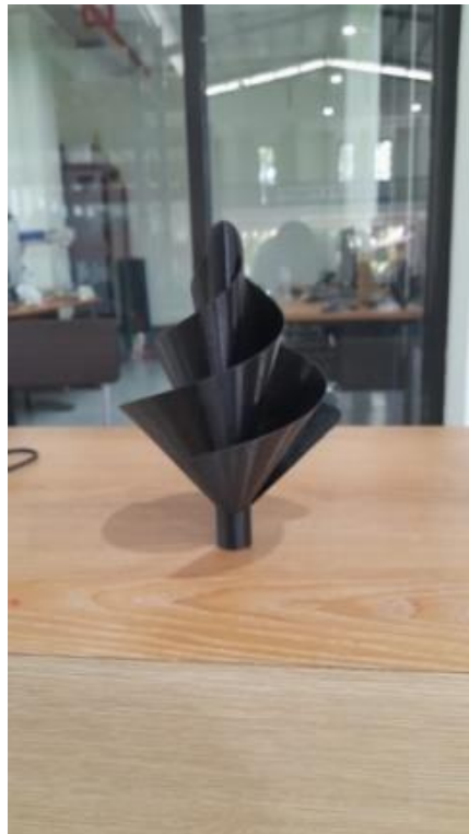
Gambar 4. 1 Hasil 3D print Bilah turbin angin archimedes 40° dengan 3 bilah
