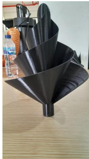
Gambar 4. 5 Hasil 3D print Bilah turbin angin archimedes 60^\circ dengan 3 bilah
