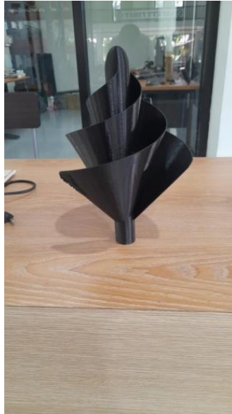
Gambar 4. 3 Hasil 3D print Bilah turbin angin archimedes 50^\circ dengan 3 bilah
