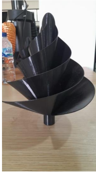
Gambar 4. 6 Hasil 3D print Bilah turbin angin archimedes 60^\circ dengan 4 bilah
