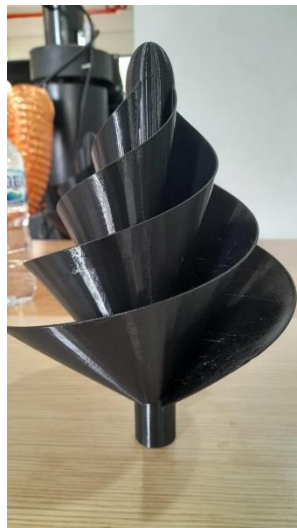
Gambar 4. 4 Hasil 3D print Bilah turbin angin archimedes 50^\circ dengan 4 bilah
