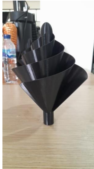
Gambar 4. 2 Hasil 3D print Bilah turbin angin archimedes 40^\circ dengan 4 bilah 4.1.2 Prototipe Bilah Sudut 50^\circ
