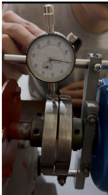
Gambar 3. 44 Posisi jam 12 pengujian bar sag
