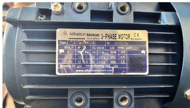
Gambar 3. 35 Spesifikasi motor listrik 3 phase
