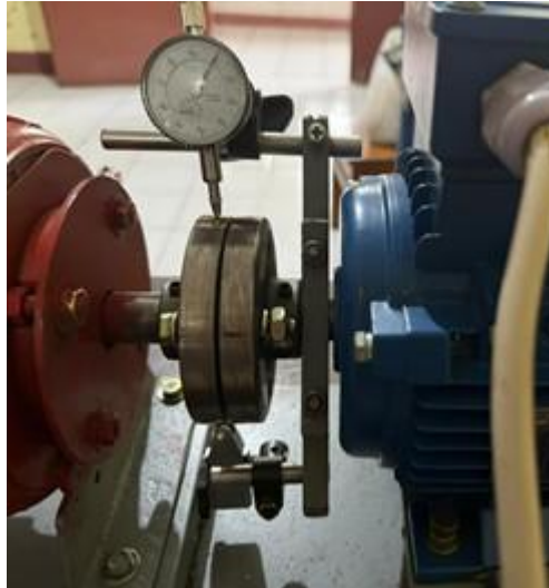
Gambar 3. 47 Pemasangan bracket dial indicator
