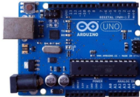
Gambar 2.3 Arduino Uno R3 (Mappa, 2019)
