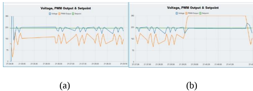
Gambar 4. 17 Grafik Node-Red Pengujian Tanpa Beban dan Menggunakan Beban PID Self Tuning 2
