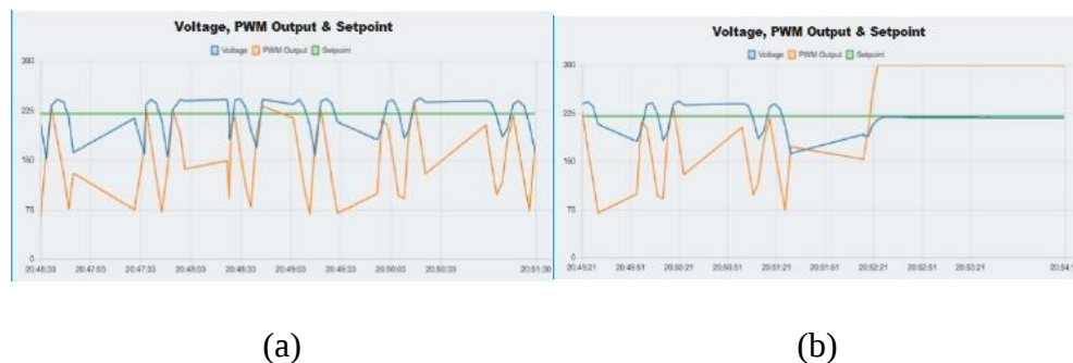
Gambar 4. 16 Grafik Node-Red Pengujian Tanpa Beban dan Menggunakan Beban PID Self Tuning 1
