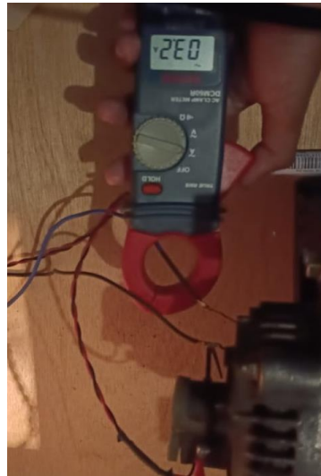
Gambar 4. 8 Pengujian Data Arus Pada Output Alternator Saat Diberi Beban 10Watt
