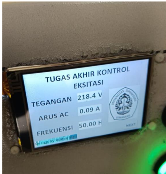
Gambar 4. 5 Pengujian Dengan Penggunaan Button Untuk Mengganti Halaman Pada HMI Nextion
