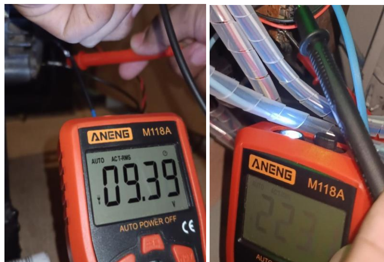
Gambar 4. 7 Data Pembacaan Tegangan Pada Output Alternator 1 Fasa Tanpa Input Beban dan Pembacaan Pada Output Tarfo Step Up
