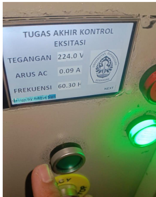
Gambar 4. 2 Peugujian Sensor PZEM-004T Pada Tampilan HMI Nextion
