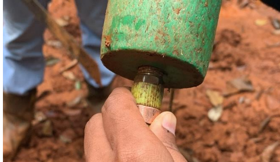
Gambar 3.11 Pemasangan komponen pemberat.
