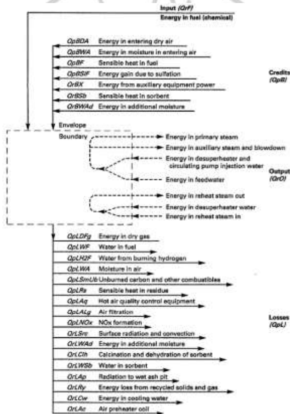
Gambar 2.2 Kesenjangan energi pada boiler (ASME PTC 4, 2013)
