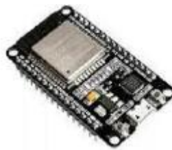
Gambar 2.7 Mikrokontroller ESP32 (Savitri dan Nina, 2022)
