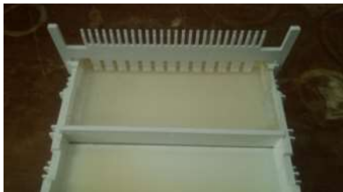
Ilustrasi 3. Proses Pencetakan Gek Agarose untuk Media Elektroforesis
