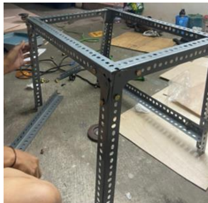
Gambar 4. 4 Perakitan dan Pemasangan Rangka Inkubator Jamur
