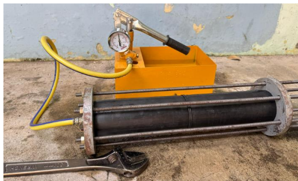
Gambar 4. 8 Proses pengambilan data pengujian hidrostatik
