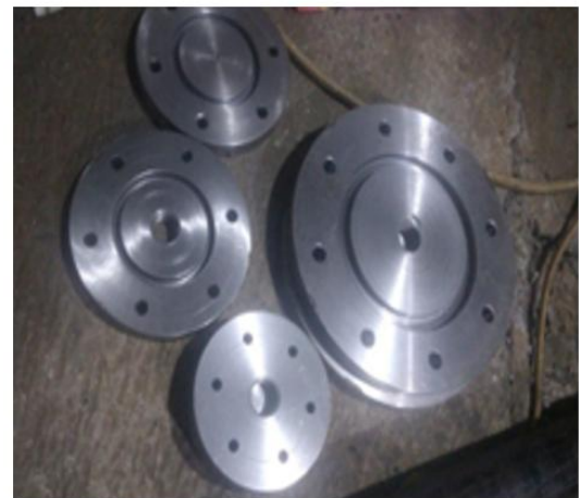
(a) (b) Gambar 4. 7 (a) Desain jig hidrostatik, (b) Hasil jadi jig pengujian hidrostatik
