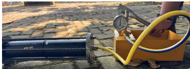
Gambar 4. 10 Proses pengujian hidrostatik pada suhu 210°C
