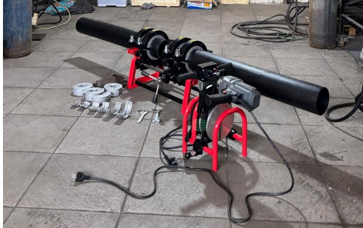
Gambar 4. 1 Proses percobaan mesin las manual butt fusion
