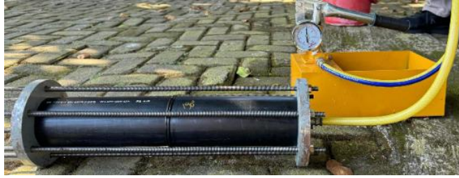
Gambar 4. 9 Proses pengujian hidrostatik pada suhu 190°C
