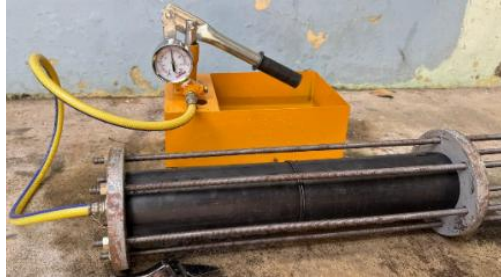
Gambar 4. 11 Proses pengujian hidrostatik pada suhu 230°C
