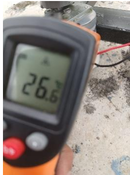
Gambar 5-17 Dokumentasi Pengujian Suhu Motor DC
