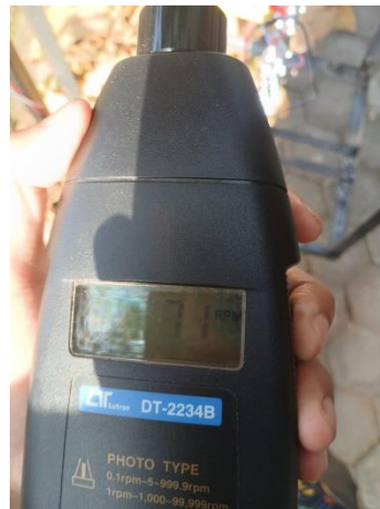
Gambar 5-22 Dokumentasi Pengujian RPM menggunakan Tachometer Pada No 1
