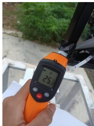
Gambar 5-18 Dokumentasi Pengujian Suhu PIR
