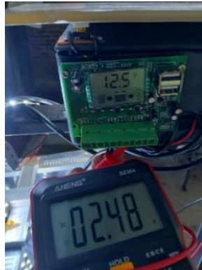
Gambar 5-10 Pengujian Konsumsi Arus dan Tegangan Kondisi 1 Pada 0 Jam
