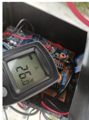
Gambar 5-15 Dokumentasi Pengujian Suhu Komponen Dalam Box
