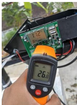
Gambar 5-16 Dokumentasi Pengujian Suhu SCC
