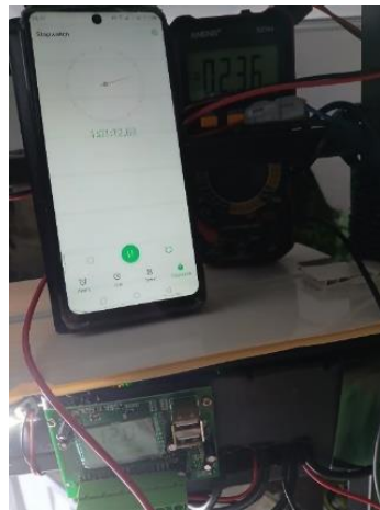
Gambar 5-11 Pengujian Konsumsi Arus dan Tegangan Kondisi 2 Pada 1 Jam
