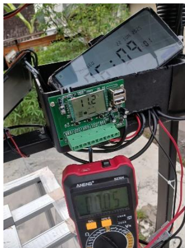
Gambar 5-7 Dokumentasi Tegangan dan Arus Panel Surya
