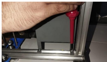
Gambar 4. 19 Pemasangan Latar / Bed (Meja Kerja)
