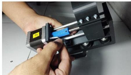
Gambar 4. 14 Pemasangan Motor Stepper NEMA 17 sumbu Z, Coupling, dan Lead Screw T8 pada Rangka Spindle dan Rangka Atas (Sumber : Dokumen Pribadi, 2025)
