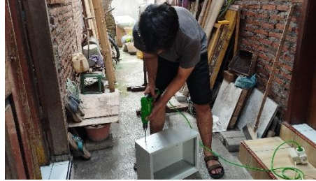
Gambar 4. 22 Pengeboran pada box panel (Sumber : Dokumen Pribadi, 2025)
