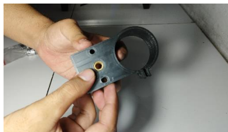
Gambar 4. 12 Pemasangan T-nut T8 lead 8 pitch 2 mm 4 start pada Rangka Spindle (Sumber : Dokumen Pribadi, 2025)
