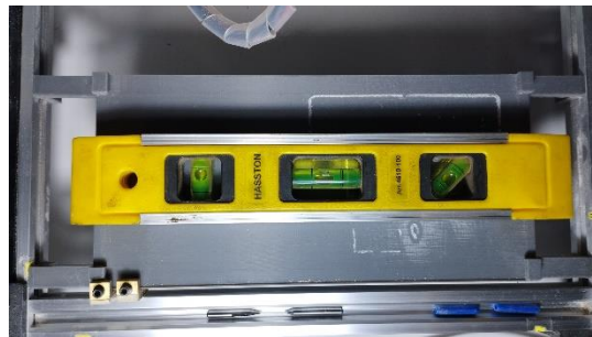
Gambar 4. 72 Proses Waterpass Test pada Bed Mesin CNC
