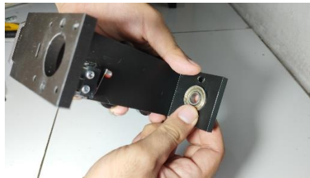
Gambar 4. 11 Pemasangan Bearing 608ZZ pada Rangka Atas (Sumber : Dokumen Pribadi, 2025)
