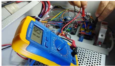
Gambar 4. 25 Pengukuran Tegangan Referensi (VRef) Driver TMC2209 (Sumber : Dokumen Pribadi, 2025)
