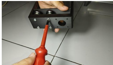
Gambar 4. 8 Pemasangan Roda V-Wheel pada Rangka Atas (Sumber : Dokumen Pribadi, 2025)
