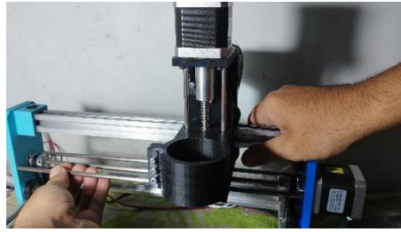
Gambar 4. 15 Pemasangan dan Perakitan Seluruh Komponen Sumbu X, Y, dan Z (Sumber : Dokumen Pribadi, 2025)
