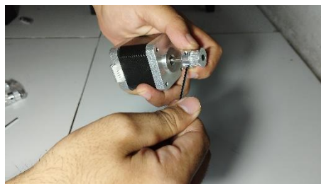
Gambar 4. 9 Pemasangan Pulley 2GT 20T pada Motor Stepper Nema 17 sumbu X
