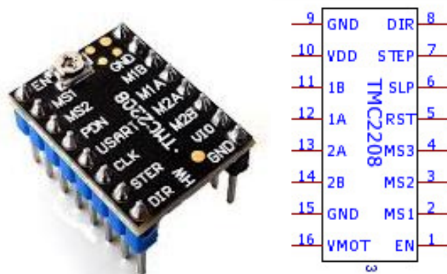
Gambar 2.10 Bentuk Fisik dan Simbol Wiring Driver Motor Stepper TMC2208
