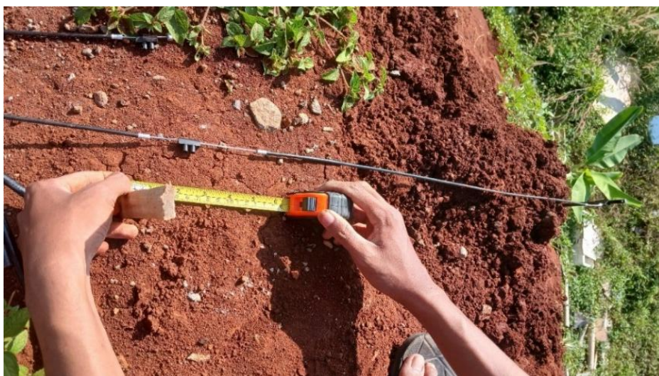
Gambar 5-5 Pengukuran Pergerakan Tanah
