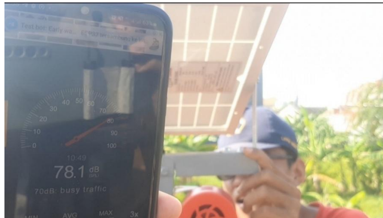
Gambar 5-6 Pengukuran Sirine Aktif
