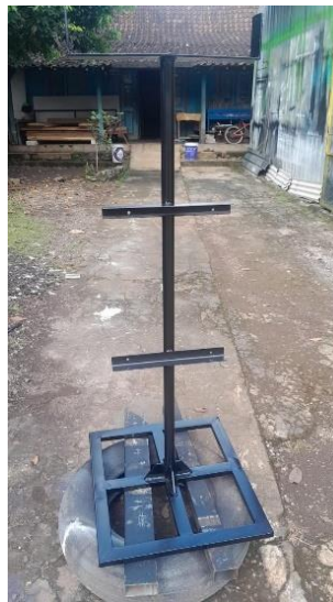
Gambar 4. 1 Tiang Penyangga Panel Surya
