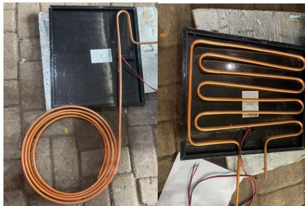
Gambar 4. 7 Pemasangan Pipa Tembaga
