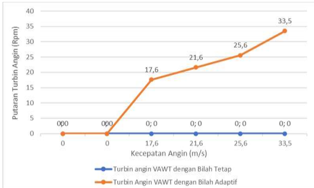
Gambar 4.12 Grafik hubungan antara kecepatan angin dengan putaran turbin angin.
