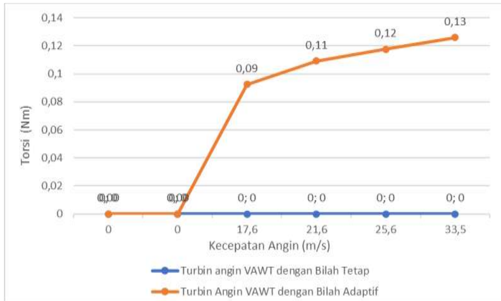
Gambar 4.11 Grafik hubungan antara kecepatan angin dengan torsi.
