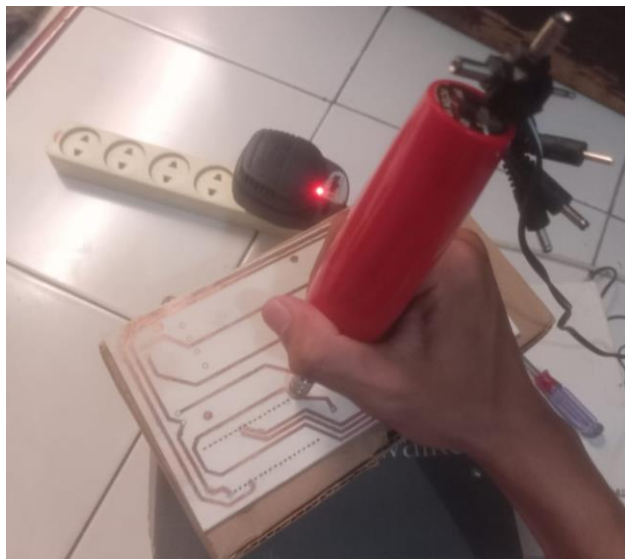
Gambar 4. 10 Proses Pengeboran Lubang PCB
