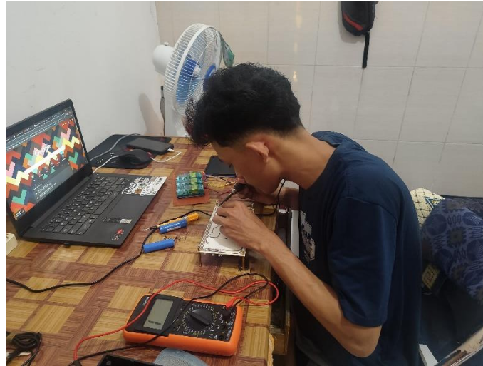
Gambar 4. 11 Proses Penyolderan Komponen ke PCB
