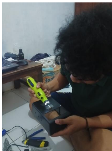
Gambar 4. 8 Melubangi komponen pada box
